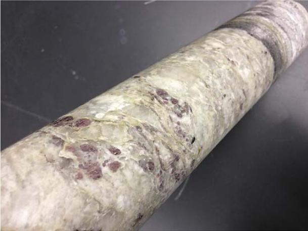
写真5 西尾市で掘削されたボーリングコア。ガーネットを含む。
