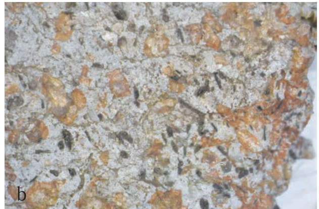
写真3 香川県高松市由良山で採取された「由良石」との比較。（a=由良石、b=名古屋市役所本庁舎外壁の剥離片）
